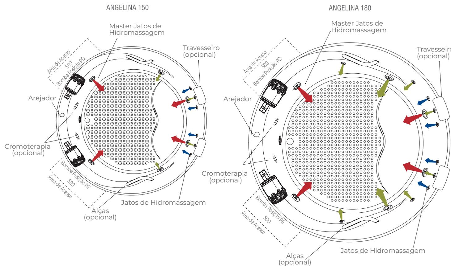
\*Dimensões em milímetros // \* Imagens meramente ilustrativas. As medidas e disposição dos jatos podem conter variações. // \* Acesso mínimo a manutenção: 500mmx350mm (comprimento x altura).
