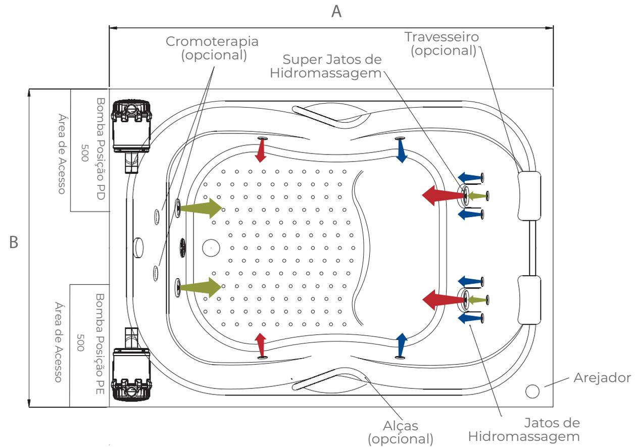
\*Dimensões em milímetros // \* Imagens meramente ilustrativas. As medidas e disposição dos jatos podem conter variações. // \* Acesso mínimo a manutenção: 500mmx350mm (comprimento x altura).
