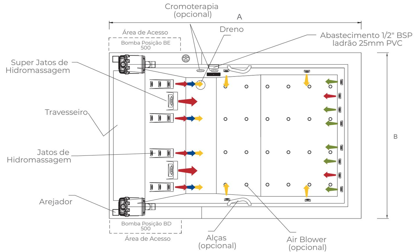
\*Dimensões em milímetros // \* Imagens meramente ilustrativas. As medidas e disposição dos jatos podem conter variações. // \* Acesso mínimo a manutenção: 500mmx350mm (comprimento x altura).
