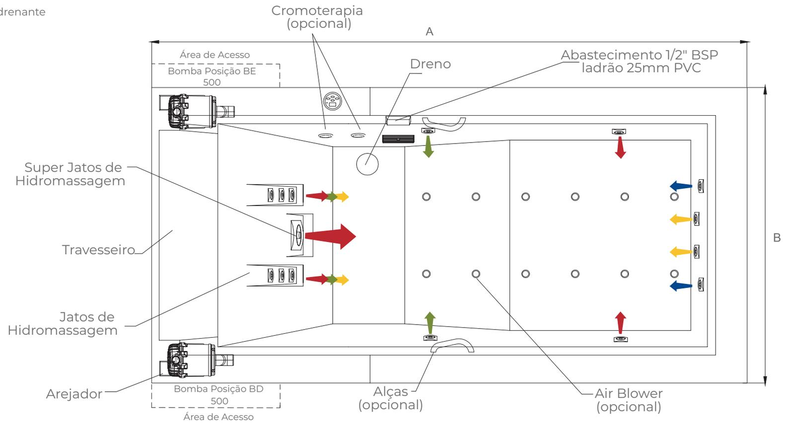
\*Dimensões em milímetros // \*Imagens meramente ilustrativas. As medidas e disposição dos jatos podem conter variações. // \* Acesso mínimo a manutenção: 500mmx350mm (comprimento x altura).
