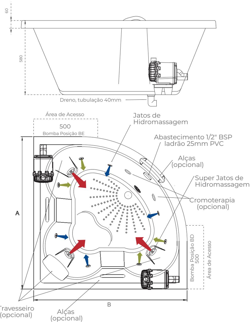
\*Dimensões em milímetros // \* Imagens meramente ilustrativas. As medidas e disposição dos jatos podem conter variações. // \* Acesso mínimo a manutenção: 500mmx350mm (comprimento x altura).
