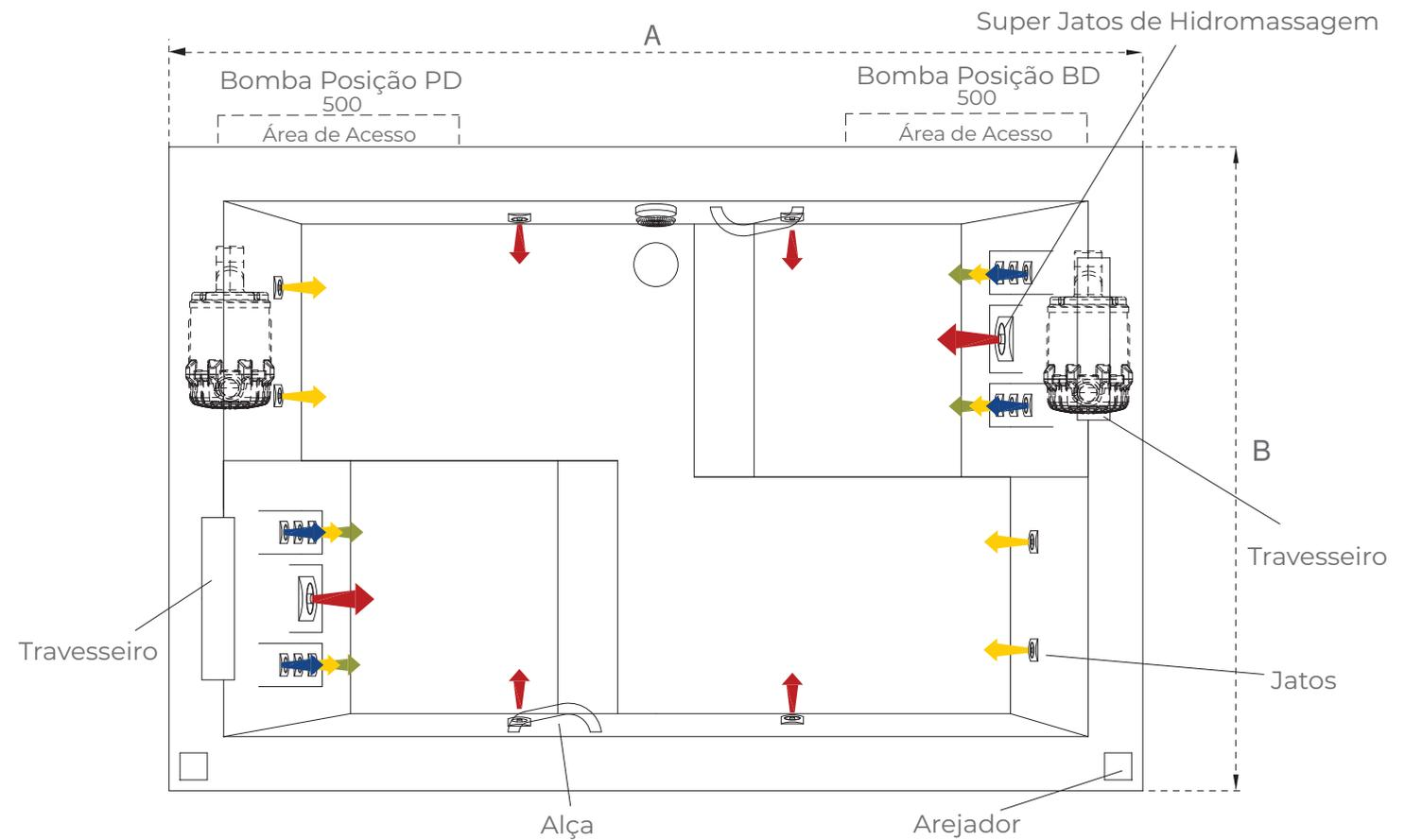
\*Dimensões em milímetros // \*Imagens meramente ilustrativas. As medidas e disposições dos jatos podem conter variações. // \*Acesso mínimo a manutenção: 500mm x 350mm (comprimento x altura);
