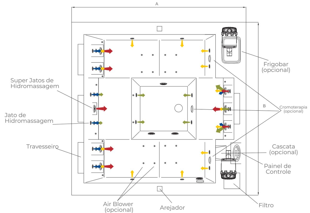
\*Dimensões em milímetros // \*Imagens meramente ilustrativas. As medidas e disposições dos jatos podem conter variações. // \*Acesso mínimo a manutenção: 500mm x 500mm (comprimento x altura).
