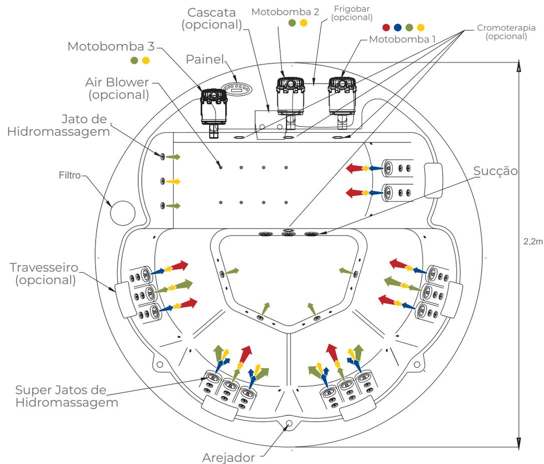
\*Dimensões em milímetros // \*Imagens meramente ilustrativas. As medidas e disposições dos jatos podem conter variações. // \*Acesso mínimo a manutenção: 500mm x 500mm (comprimento x altura).
