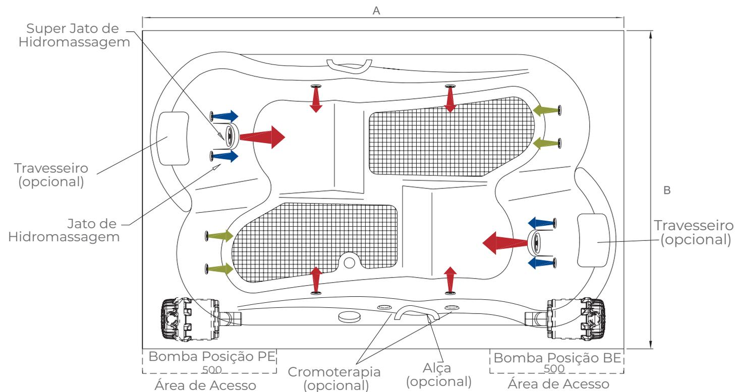
\*Dimensões em milímetros // \*Imagens meramente ilustrativas. As medidas e disposições dos jatos podem conter variações. // \*Acesso mínimo a manutenção: 500mm x 350mm (comprimento x altura);
